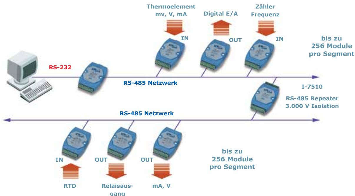
**Bis 256 Module ohne Repeater - Erweiterung um jeweils 256 Module mit I-7510 Repeater - maximal 2.048 Module im Netzwerk**
